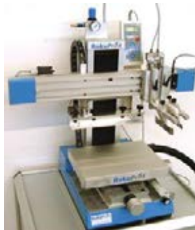
Machines de sérigraphie universelles pour l'impression à plat, sur objets et cylindres.
