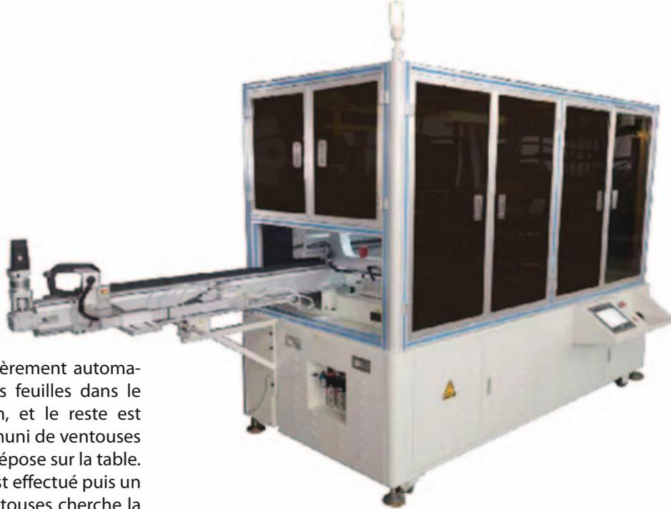
C'est une machine entièrement automatique ! Vous placez vos feuilles dans le magasin d'alimentation, et le reste est automatique. Un bras muni de ventouses cherche la feuille et la dépose sur la table. Le cycle d'impression est effectué puis un autre bras muni de ventouses cherche la feuille et la dépose sur le tapis de votre tunnel.
