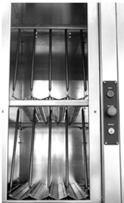
La chambre de séchage séparée accélère l'ensemble du processus, car il est possible de sécher et laver simultanément.
