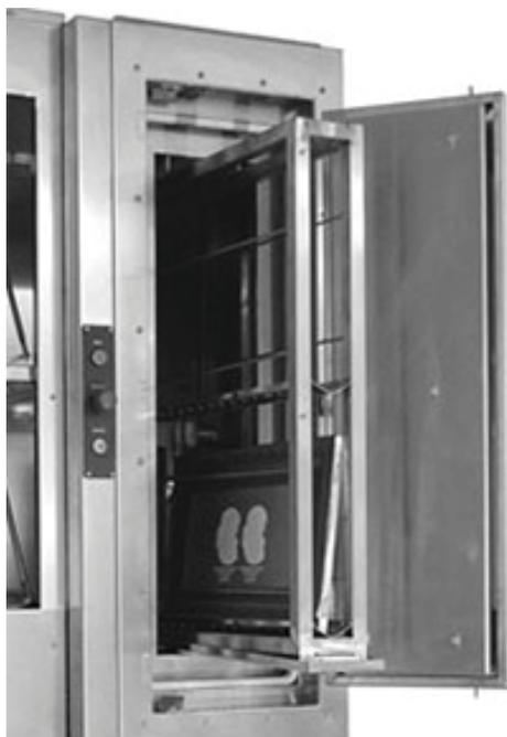
Grâce au bac de récupération situé sous le cadre de maintien de l'écran, le solvant ne goutte pas dans la zone de l'opérateur !
