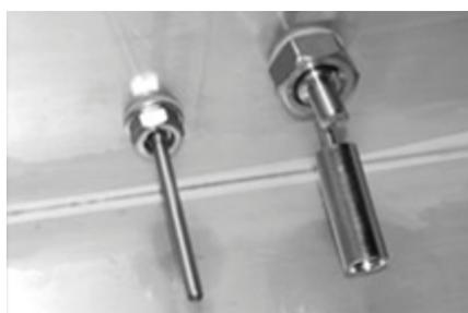
Les dispositifs de surveillance dans le réservoir de solvant, réalisés en acier inoxydable.
