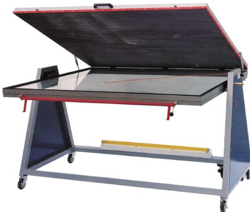
Châssis à vide, mobile. Avec tapis caoutchouc 100% Latex ayant une capacité d'extension de 600%; vitre de haute qualité; pompe à vide haute performance; rotation à 360° du châssis à 4 positions; ajustement automatique du vide; maintien du châssis par ressorts à gaz; dispositif anti-statiques.
