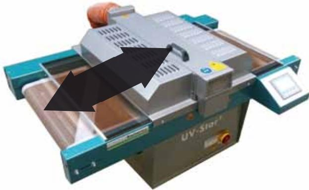
Les tunnels UV de la gamme BT peuvent être équipés d'un mode "aller/retour" permettant à l'opérateur de récupérer la pièce polymérisée à l'entrée du tunnel. Ils sont également équipés d'un mode ECO qui place la lampe en veille (1/4 de puissance) tant qu'il n'y a pas de pièces sur le tapis. Les deux modes sont utilisables en même temps. Ces fonctions sont disponibles sur l'ensemble de la gamme.
